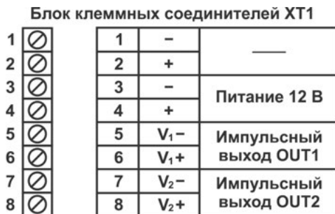
Рисунок 1.6 – Схема подключения числоимпульсного выхода
