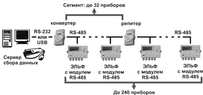
Рисунок В.3 – Принципиальная схема передачи данных по интерфейсу RS-485
