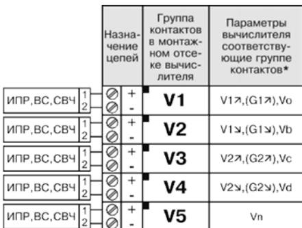
Рисунок 2.6 – Схема подключения к вычислителю ИПР, ВС, СВЧ
