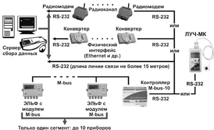
Рисунок В.2 – Принципиальная схема передачи данных по интерфейсу M-Bus при использовании контроллера M-bus-10
