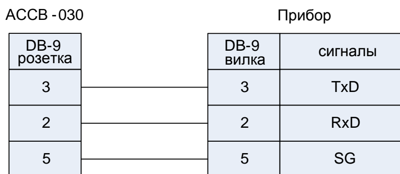
Рис.3. Подключение прибора по интерфейсу RS-232.
