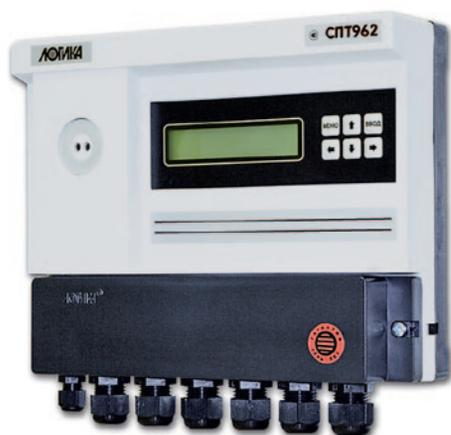
Тепловычислители рассчитаны на работу совместно с датчиками расхода, объема, разности давлений, давления и температуры. К тепловычислителю могут быть одновременно подключены: восемь преобразователей с выходным сигналом тока 0–5, 0–20 или 4–20 мА; четыре преобразователя с выходным числоимпульсным или частотным сигналом; четыре термопреобразователя сопротивления Pt100, Pt50, 100 П, 50 П, 100 М, 50 М.
