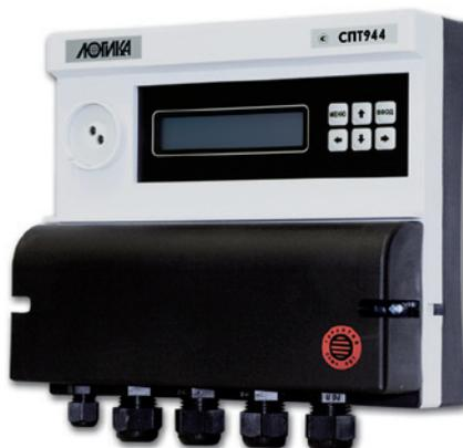
К тепловычислителю могут быть подключены: шесть преобразователей расхода с импульсным выходным сигналом частотой до 1 кГц и нормированной ценой импульса (питание преобразователей, работающих при напряжении 3,2 – 3,6 В, обеспечивается непосредственно от тепловычислителя); шесть преобразователей температуры с характеристикой Pt100 или 100П; шесть преобразователей давления с выходным сигналом 4–20 мА.
