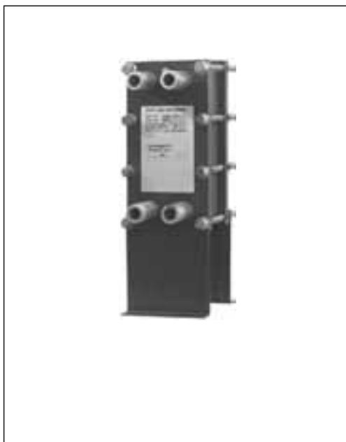
Разборный теплообменник XG 10 применяется в системах отопления, горячего водоснабжения, холодоснабжения для вентиляционных установок и кондиционеров. Количество пластин в теплообменнике зависит от требуемой теплопроизводительности, диапазона температур и допустимого перепада давлений. Теплообменник устанавливается на ровном полу без специального фундамента и может разбираться для очистки и модернизации.
