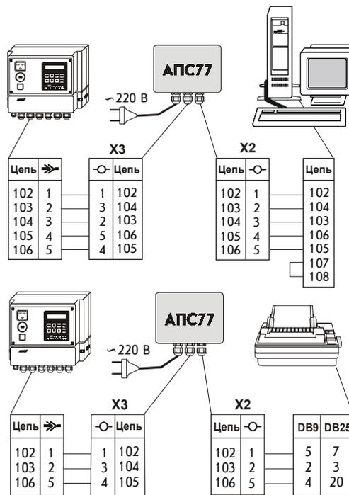
Рис.2. Подключение оборудования к адаптеру АПС77
