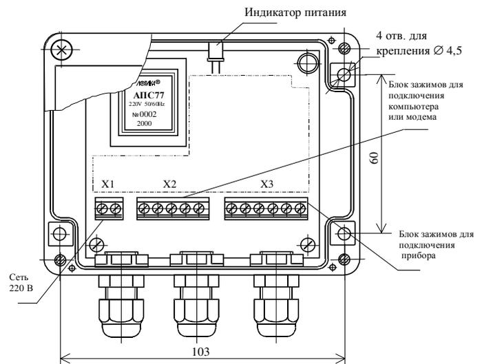
Рис.4 Присоединительные размеры корпуса адаптера АПС77
