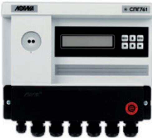
Корректоры СПГ761 (мод. 761.2, 761.3 761.4) предназначены для измерения электрических сигналов, соответствующих параметрам природного газа, и последующего вычисления расхода и объема газа, приведенных к стандартным условиям ( $T_c=20^{\circ}\text{C}$ ,  $P_c=0,101325\text{ МПа}$ ).
