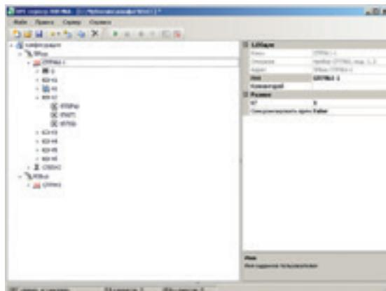
Поддерживает стандарты OPC DA v.3.0 и OPC HDA v.1.20 и передает в SCADA-систему (или в другую автоматизированную систему) текущие и архивные значения измеряемых и вычисляемых параметров. Поддержка стандарта OPC HDA позволяет наиболее полно использовать все возможности приборов фирмы, в том числе при создании автоматизированных систем коммерческого учета.
