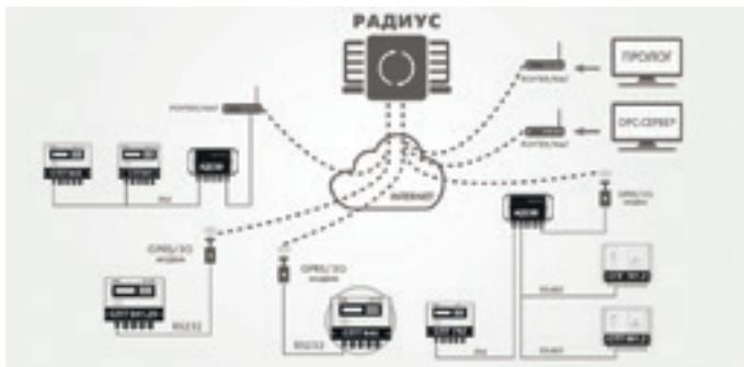
(ПРОЛОГ или ОРС-сервер ЛОГИКА). Канал связи защищен с помощью алгоритмов авторизации и шифрования.
