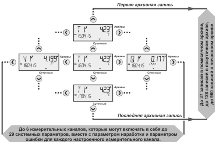
**Рисунок 3.2** – Структура архива вычислителя
