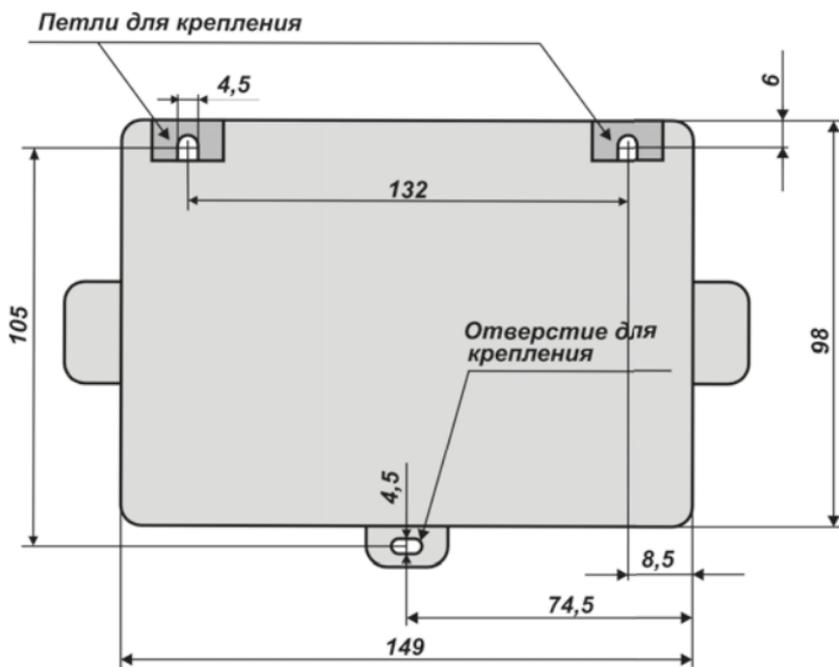
*Рисунок А.2 – Установочные размеры вычислителя*
