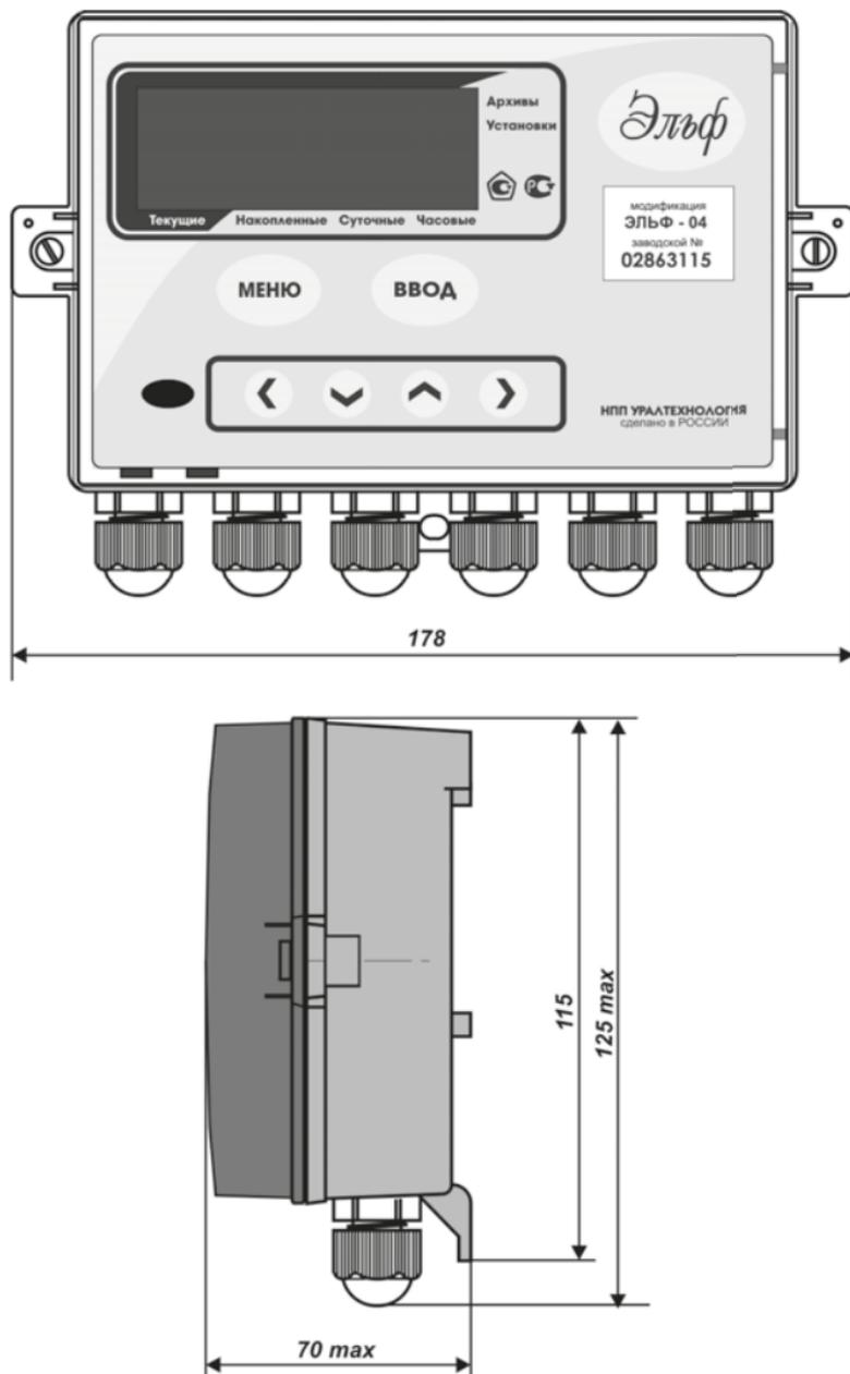
Рисунок А.1 – Габаритные размеры вычислителя
