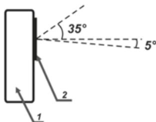
1 - корпус вычислителя (вид сбоку); 2 - экран ЖКИ вычислителя
