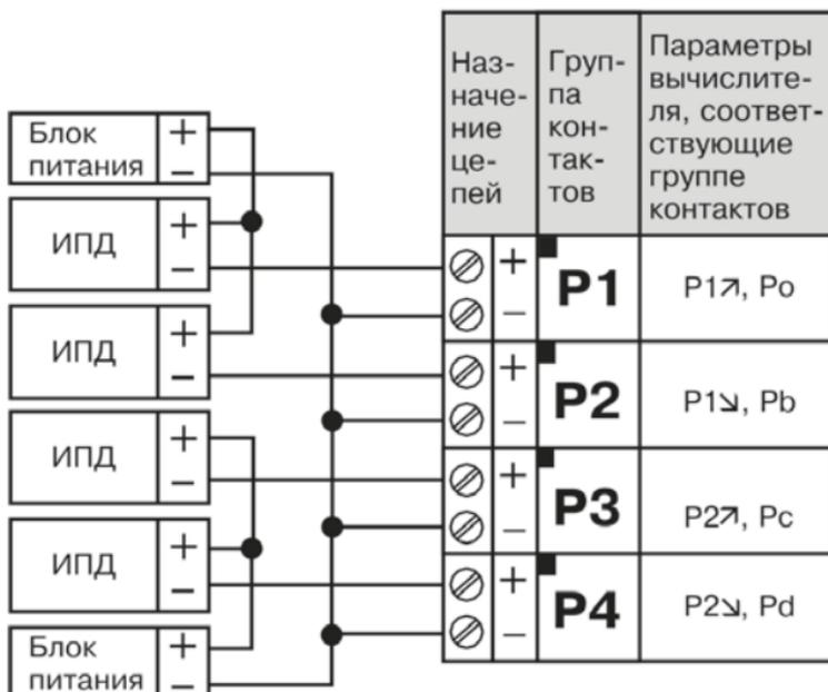
Рисунок В.2 – Схема подключения к вычислителю ИПД
