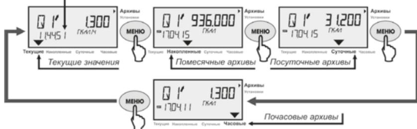
**Рисунок 3.3** – Переход между различными архивами вычислителя
