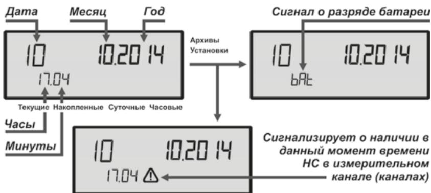
**Рисунок 3.1** – Изображение стартового экрана вычислителя
