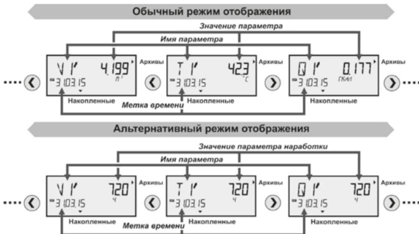
**Рисунок 3.4** – Пример отображения данных в помесечном архиве
