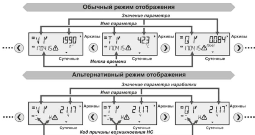
**Рисунок 3.5** – Пример отображения данных в посуточном архиве
