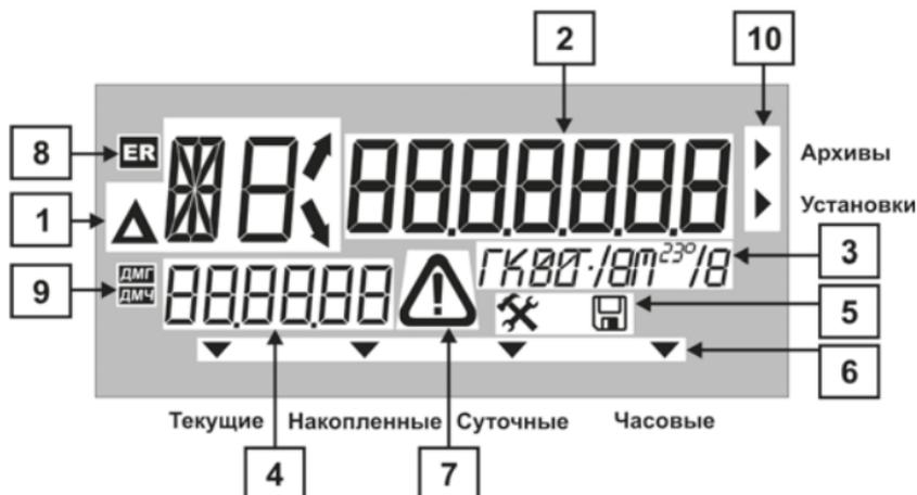
**Рисунок 2.2** – Информационные поля, отображаемые на экране ЖКИ вычислителя
