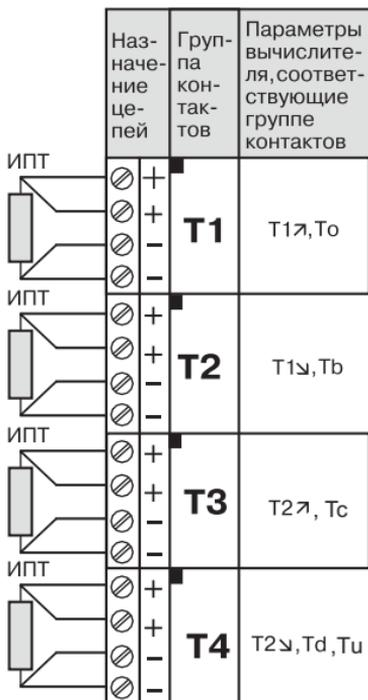
2-х проводная схема подключения
