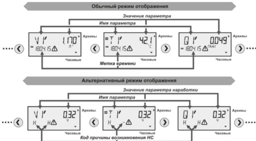
**Рисунок 3.6** – Пример отображения данных в почасовом архиве
