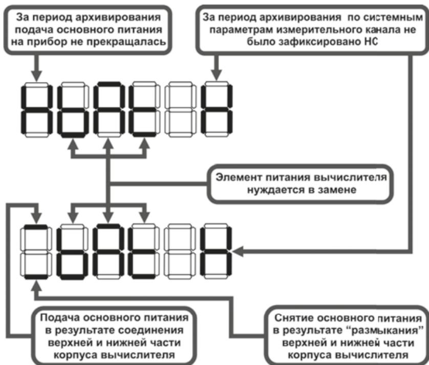
**Рисунок 3.7** – Коды НС, возникающих по техническим параметрам
