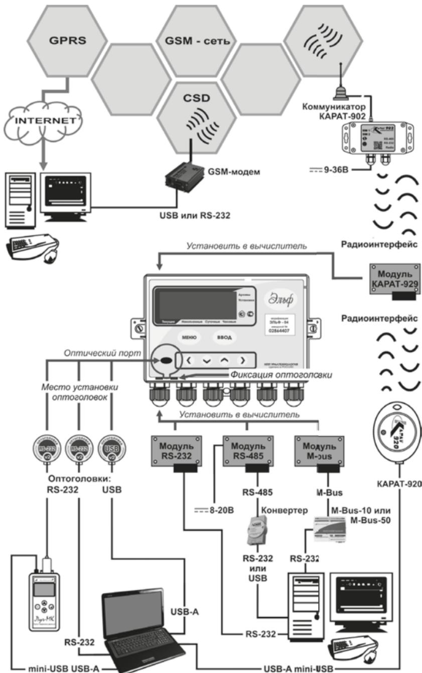
Рисунок 1.3 – Коммуникационные возможности вычислителя
